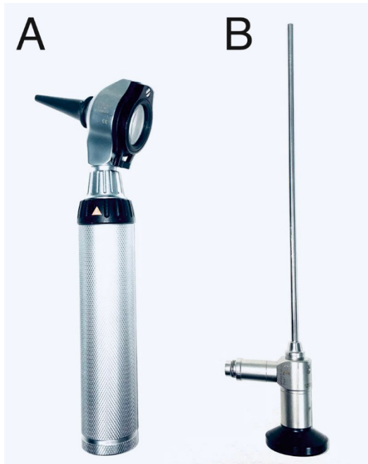
Abbildung 2: Das Foto zeigt ein handgeführtes Otoskop (A) und ein starres 0-Grad 4-mm-Endoskop (B).
